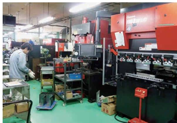
サイドガードと光線式安全装置がつけられたFMB II-3613NT
