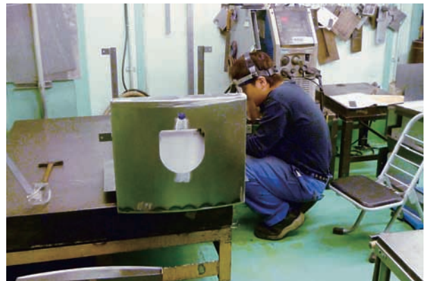
SPCC の筐体を溶接する
